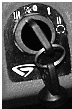
Рисунок 2.2.2 – Схема положений выключателя стартера и приборов
